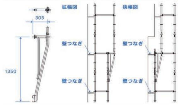
注1 壁つなぎは拡幅狭幅兼用ブラケット取付け部の引張り側及び、圧縮側布材位置と支柱の交点付近に全スパンにわたって取付けること。
